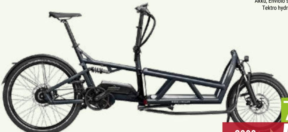
Wartungsarmer Gates Riemenantrieb
